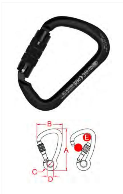
Moschettone in alluminio con ghiera Twist Lock. La serie X-Large è concepita per offrire ampia apertura della leva e un elevato carico di rottura. La particolare forma a D evita la rotazione del moschettone e permette di distribuire maggiormente il carico lungo l'asse maggiore.
