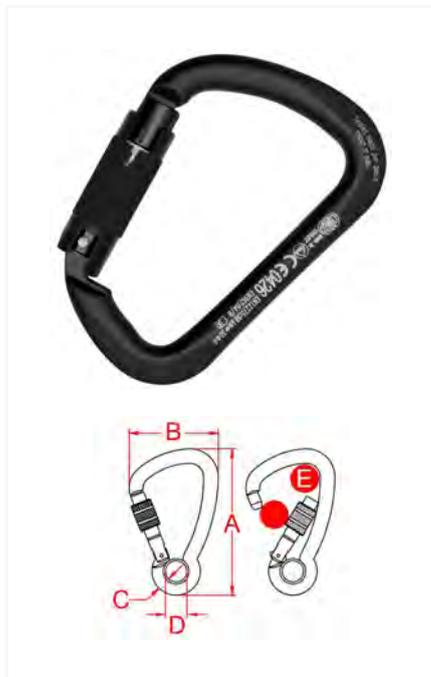
Moschettone in alluminio con ghiera Auto Block. La serie X-Large è concepita per offrire ampia apertura della leva e un elevato carico di rottura. La particolare forma a D evita la rotazione del moschettone e permette di distribuire maggiormente il carico lungo l'asse maggiore.
