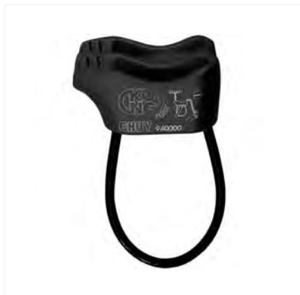
Chuy è un assicuratore discensore che funziona su mezze corde, corde gemelle e corde singole. Molto leggero, ha il pregio di poter variare la capacità frenante grazie alle gole a "V" così da modulare lo sforzo dell'utilizzatore in base al proprio peso, alla corda utilizzata e a tutti quei fattori che modificano l'attrito e di conseguenza la frenatura. Fluidità di funzionamento, ottimo frenaggio e look accattivante. Ne consigliamo l'uso in abbinamento ad un connettore HMS con ghiera a vite.
