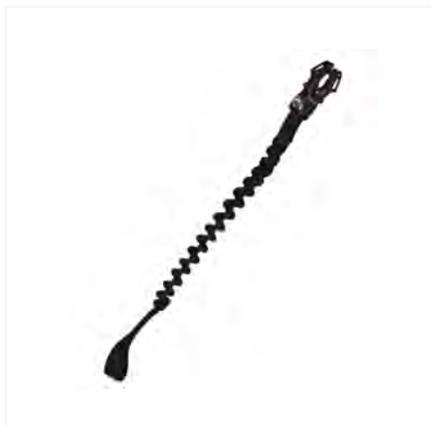
Longe di posizionamento elastica Yates Tactical, da utilizzare durante operazioni con elicottero. Dotato di un connettore Kong mod. FROG con chiusura automatica per agganciarsi direttamente agli anelli che si trovano sul pianale dell'elicottero. L'altra estremità permette di agganciare la longe all'imbracatura.
