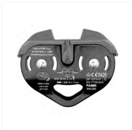
Carrucola con corpo in alluminio e doppia puleggia in acciaio inox. Utilizzo su corde o cavi d'acciaio di diametro massimo 13 mm.
