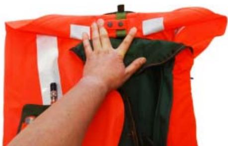
**Figura 44 - Piegare la camera di galleggiamento**
