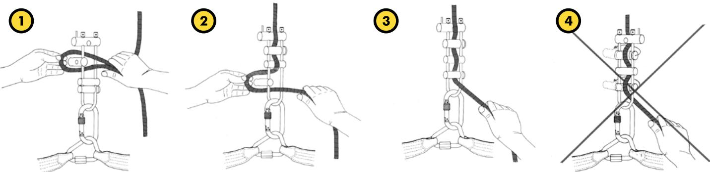
Per eseguire questa operazione è importante attenersi scrupolosamente ai disegni esplicativi. La corda, inserita correttamente, alloggia nelle gole di scorrimento delle prime due barre e spinge le barre apribili contro il corpo dell'attrezzo.
