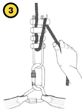
Con corde normali (diametro 10 mm) basta variare, con la mano di regolazione, l'angolo di entrata della corda avvicina le barre mobili. (1)
