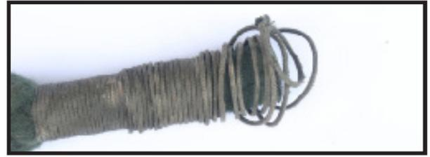
**Figura 3: Terminale danneggiato da sostituire**
