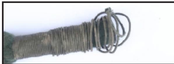
**Figura 3: Terminale danneggiato da sostituire**
