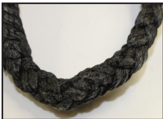
Figura 11: Normale abrasione superficiale in un anello
