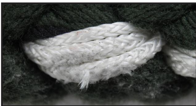
**Figura 7: abrasione superficiale della terminazione DLT**
