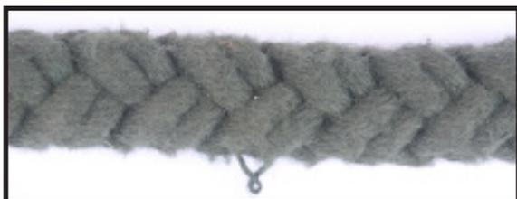
**Figura 2: Anello di filo tirato di lunghezza inferiore a 25 mm**
