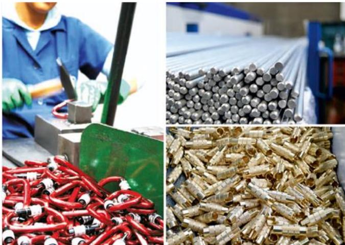
O último elemento para analisarmos são as porcas, obviamente para produtos que usam este tipo de trava para alavanca, para construir basicamente é o mesmo processo da alavanca trocando alguma fase de acordo com macho e Fêmea da rosca. A porca acabada segue testes específicos para atender a norma de referimento que deve ser seguida para este componente do conector. A prova é um teste de resistência a compressão seguido por uma força em dois vetores ortogonais entre eles.
