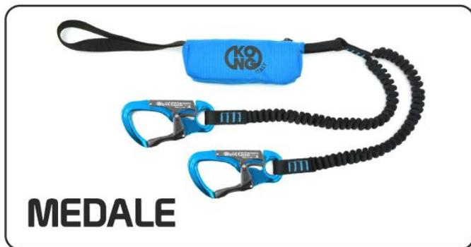
Equipamentos similares são utilizados inclusive na parte esportiva ou lúdica do montanhismo, por exemplo em vias ferratas. A Nova norma EN 958:2017 consta que o produto deve garantir não ultrapassar a força de 3,5 KN para massa de 40 kg e 8KN para uma massa de 120 kilos dando assim uma maior garantia ao utilizador final.
