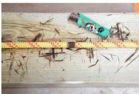
Passo 1 – utilizando um isqueiro ou soprador térmico, queime a parte da capa onde irá realizar o corte. Esta operação é importante afim de não deixar a capa abrir após cortada mas não é extremamente necessária, digamos que é um bom conselho.
