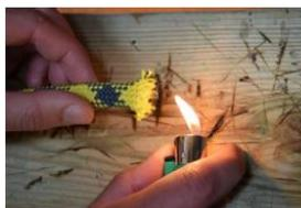
Passo 6 – esquentar com um isqueiro a capa até as duas partes se fundirem, a solda deve ser completa, fechando totalmente e cobrindo a alma de forma circular, não deve haver pontas na emenda.
