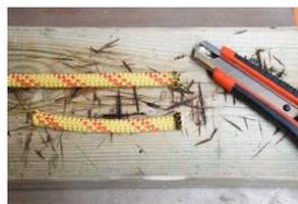
Passo 2 – corta a corda na marca queimada, com uma tesoura ou cortador, se utilizar o estilete atenção pois sua lâmina não foi feita para ser utilizada como uma faca, ela irá quebrar e lhe machucar.
