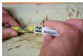
Passo 7 – todas as informações da corda devem estar marcadas, comprimento, data de inspeção etc. realizar esta inspeção ao menos a cada 12 meses e colocar a etiqueta termo retrátil na ponta
