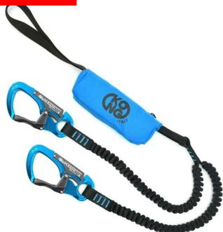
Set da ferrata a Y realizzato con fettuccia elastica da 20 mm e connettori Tango a doppia leva di sicurezza. Dotato di cuciture ad alto carico e dissipatore facilmente ispezionabile grazie alla pratica custodia con zip. Conforme ai requisiti di sicurezza previsti dalla nuova revisione della norma EN 958:2017 che prevede un carico d'uso compreso tra 40 e 120 kg. Lunghezza totale del set: min. 85 cm - max. 120 cm.
